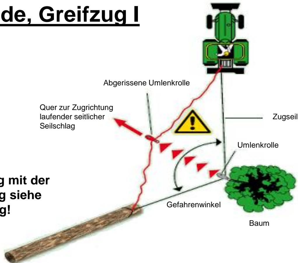
**Wird das Seil unter Spannung gesetzt, darf sich in der Nähe des Seiles niemand aufhalten.**
