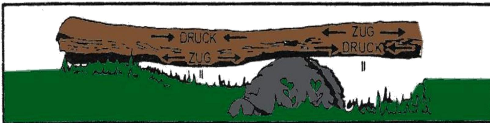
Liegendes oder stehendes Holz, das unter Spannung steht, erst auf der Druckseite einschneiden, danach Trennschnitt von der Zugseite aus durchführen.
